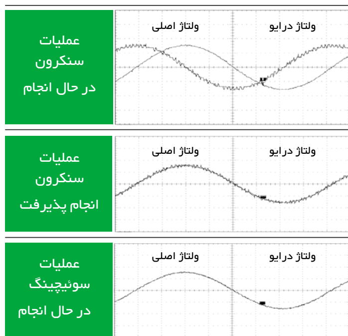
شکل ۳. سنکرون کردن / قطع کردن در زمان همگام بودن
