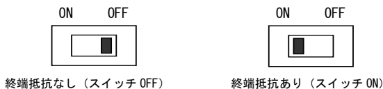
図 2.2 終端抵抗 ON/OFF スイッチの設定
